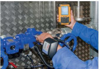
A criação de base de dados com todas as informações relevantes de cada purgador instalado num determinado sistema, registo de comentários e respectivas curvas de medição dos testes efectuados, permite uma análise global e detalhada de toda a instalação dos purgadores possibilitando a emissão de relatórios de acompanhamento com a listagem dos equipamentos testados, notificação dos purgadores defeituosos e respectivas perdas de vapor que estão a ocorrer.
